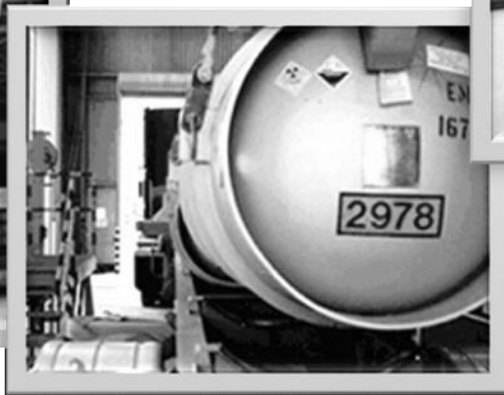
Контейнеры, используемые для хранения и транспортирования ОГФУ
